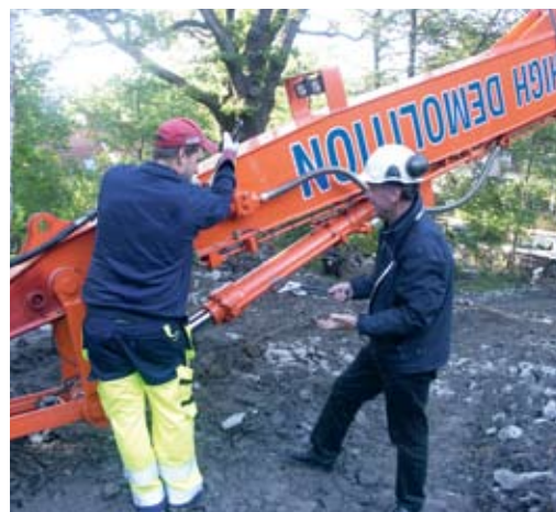
Mattias och Bosse i färd med att låsa den 27 m långa bommen på Doosan-maskinen före transport.
