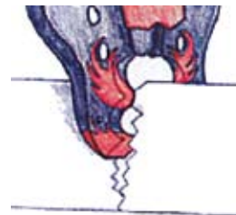
Den kilformade käften bryter sedan betongen i dess längdriktning.
