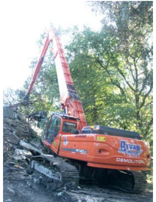
RIVAB har Nordens första modell den rivningsutrustade Doosan DX420LC med en bom på 27 m. Återförsäljare för Doosan i Sverige är Maskinia i Linköping.
