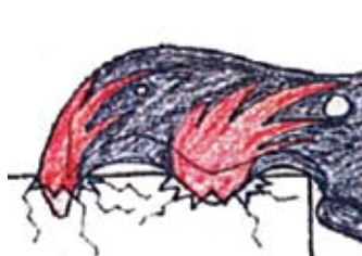
Den avrundade inre klon överför kraften i betongen oavsett vinkel och bildar en spricka.
