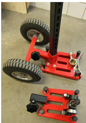
Golv- och väggborring med 40 + stämpstativ samt närbild av expanderfot och bultplatta.
